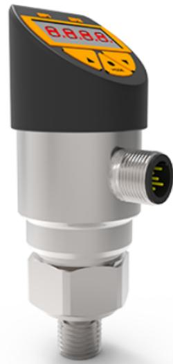
P4001智能压力开关是一款集压力测量、显示、输出与控制为一体的智能数字压力开关。采用高精度硅压阻压力传感器，输出信号由高精度，低温漂放大器放大处理，送入高精度的 A/D 转换器，转换成微处理器可以处理的数字信号，经过运算处理的信号控制两路开关，对控制系统压力进行测控。该智能数字压力开关使用灵活，操作简单，调试容易，安全可靠。广泛应用于水电，自来水，石油，化工，机械，液压等行业，对流体介质的压力进行测量显示和控制。
